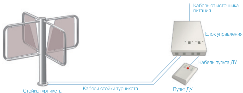
Схема подключения турникета PERCo-RTD-03S
