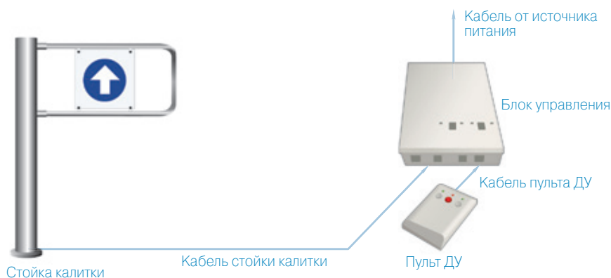
Схема подключения калитки PERCo-WMD-05S
