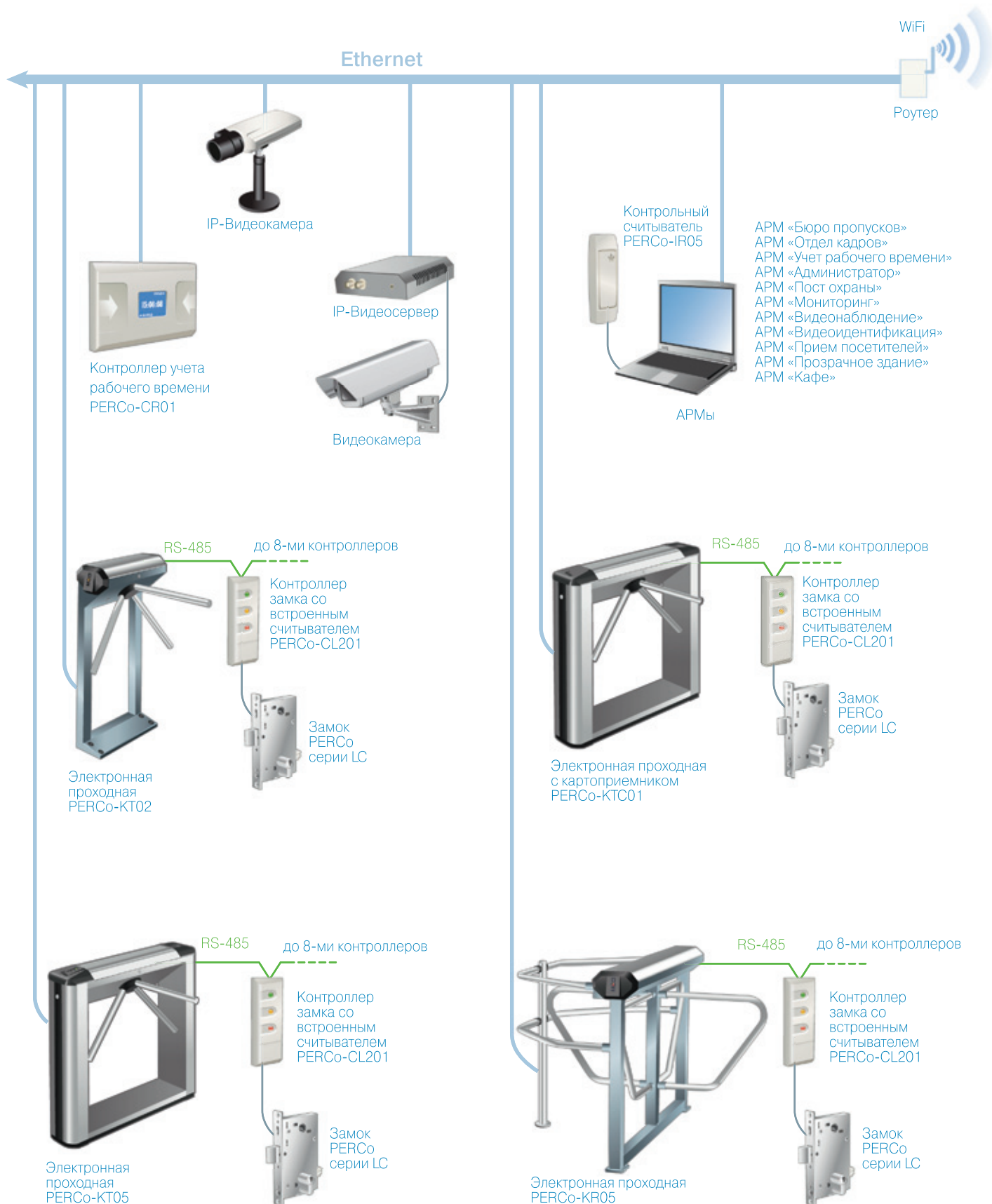
Структурная схема Системы контроля доступа PERCo-S-20
