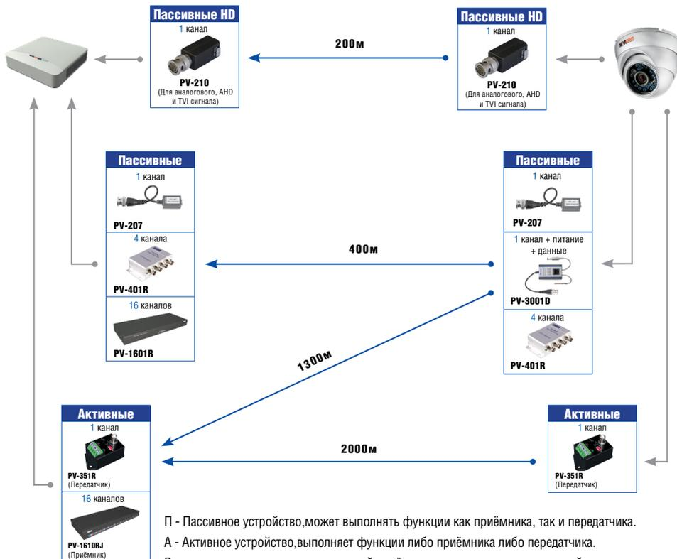
П - Пассивное устройство, может выполнять функции как приёмника, так и передатчика.
